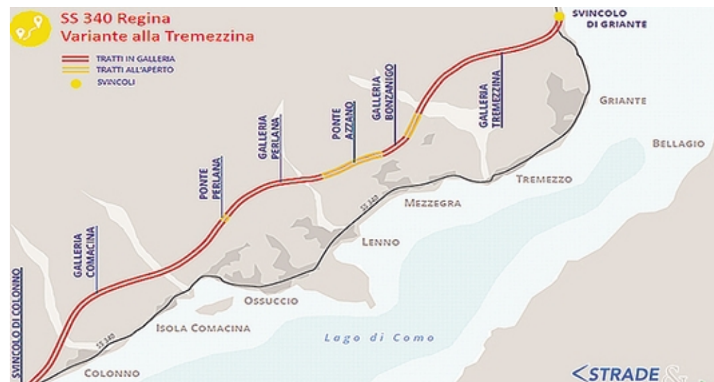
Il tracciato della Variante della Tremezzina, con lunghi tratti in galleria
